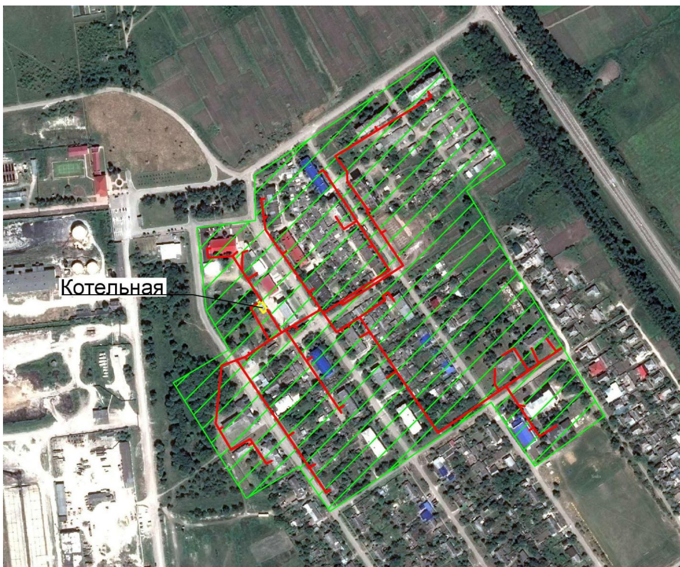
Рис. 2.3 – Зона теплоснабжения котельной, п. Малороссийский, ул. Мира, 4а
